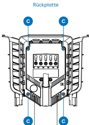
Wenn Sie weniger als 4 Laderoboter installieren, decken Sie die restlichen Seiten mit der Multi-Way-Abdeckung ab. Vor dem Anbringen der Abdeckung muss die Abschirmungslasche hochgeklappt werden, um die Abdeckung mit 4 Linsenkopfschrauben zu befestigen.
