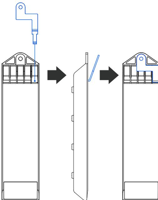
2. Setzen Sie die gezackte Unterlegscheibe auf die Stange in der Säule ein. Sie sollte zwischen der Metallsäule und der Power Rail platziert werden.
