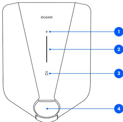
1. **Pulsante touch:** il pulsante touch viene utilizzato per attivare l'interfaccia locale. L'interfaccia locale è destinata alle operazioni locali del caricatore quando non è disponibile un collegamento Internet. Leggere di più sull'interfaccia locale alla pagina: [easee.com/support/localinterface](https://easee.com/support/localinterface).
